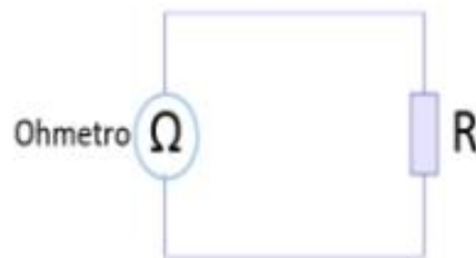
Circuito electrónico: medición de resistencia
