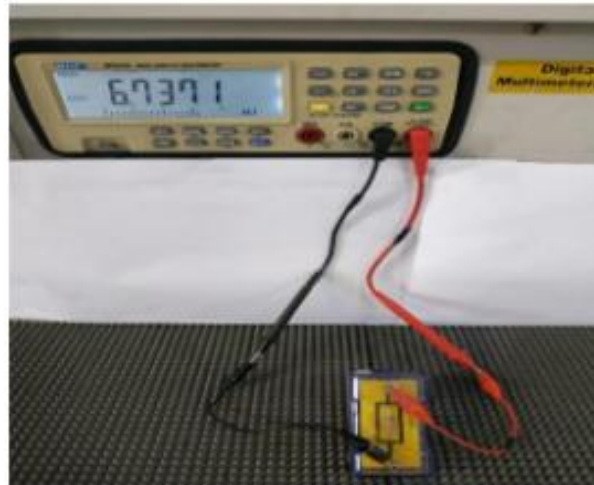
Circuito físico: Medición de la resistencia
